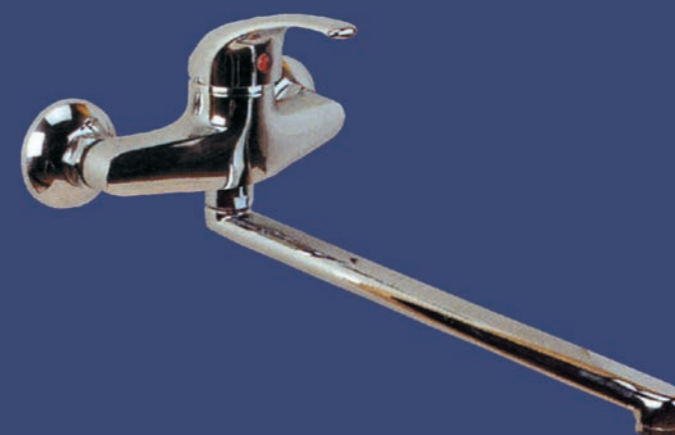
4033 MISCELATORE MONOCOMANDO LAVELLO A PARETE Bocca di erogazione girevole mm. 200 o 300, eccentrici da 1/2" regolabili per interasse da mm. 150±15 WALL MOUNTED SINGLE LEVER SINK MIXER Swivel spout mm. 200 or 300, s-tailpieces with 1/2" connections, centre distance mm. 150±15
