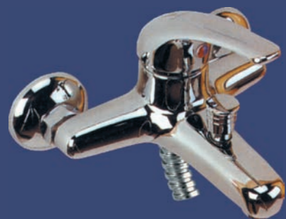
4005 MISCELATORE MONOCOMANDO VASCA ESTERNO Deviatore automatico, duplex con flessibile mm. 1500, eccentrici da 1/2" regolabili per interasse da mm. 150±15 EXTERNAL SINGLE LEVER BATH MIXER Automatic diverter, duplex with shower hose mm. 1500, s-tailpieces with 1/2" connections, centre distance mm. 150±15
