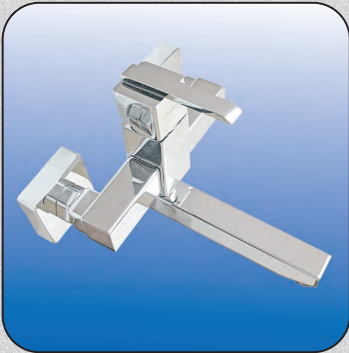
Art. 5033 MISCELATORE MONOCOMANDO LAVELLO A PARETE Bocca di erogazione girevole mm. 200 o 300, eccentrici da 1/2" regolabili per interasse da mm.150 ± 15
